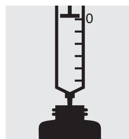
Tropfrohr der Titrierpipette mit Reagenz R-3 füllen.
