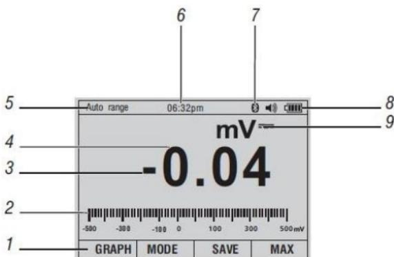
1. Zuordnung der Drucktasten: zeigt die Funktion der Drucktaste direkt unterhalb der angezeigten Markierung
