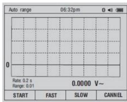
Drücken Sie die Taste „F1“ (START). Um eine schnelle oder langsame Abtastrate auszuwählen, drücken Sie die Tasten „F2“ (FAST) oder „F3“ (SLOW). Drücken Sie Taste „F4“ (CANCEL“, um die grafische Messwertdarstellung zu verlassen und zum normalen Messbetrieb zurückzukehren.
