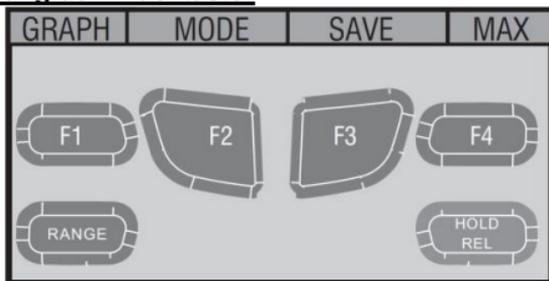
Die 6 Drucktasten auf der Frontplatte des Multimeters aktivieren Funktionen, die die Messfunktionen, welche über den Drehschalter ausgewählt wurden, erweitern. Mit den Tastern kann nun innerhalb der Menüs navigiert werden.
