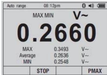
Um den MAX / MIN-Modus zu aktivieren, drücken Sie die Taste "F4" (max / min), im normalen Messbetrieb.
