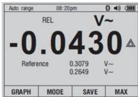
Die Relativwert-Messfunktion gestattet die Messung und Anzeige von Signalen bezogen auf einen definierten Referenzwert. REL-Taste 1 x drücken. Der angezeigte Messwert wird auf 0 gesetzt. Bei einem Referenzwert von 100 V z. B. und einem tatsächlichen Messwert von 90 V, wird in der LCD-Anzeige -010,0 V angezeigt. Sind Referenzwert und Messwert identisch, zeigt die digitale Anzeige den Wert "0".
